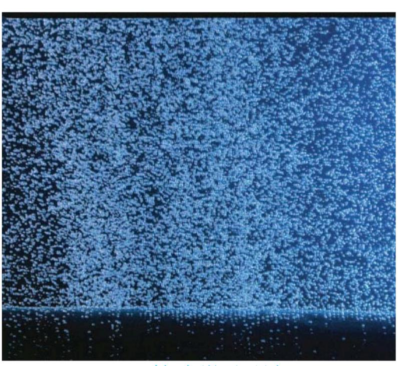
BIOFLEX 管式微孔曝气器
